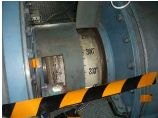
X Y Z 3方向振動、回転数を計測
